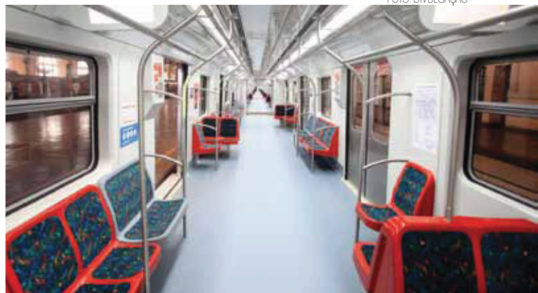
Os novos trens da Linha 8 da CPTM possuem passagem livre entre os carros
