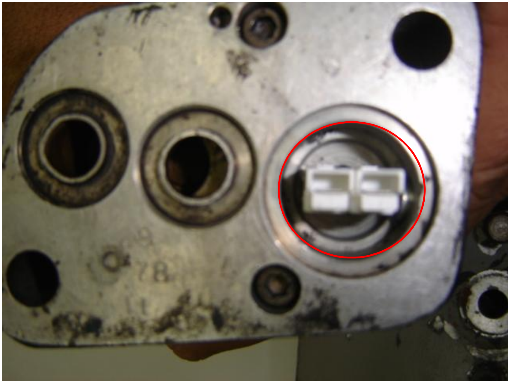
FIGURA 4: CONTATO ORIGINAL RETIRADO DA BASE DA VÁLVULA
