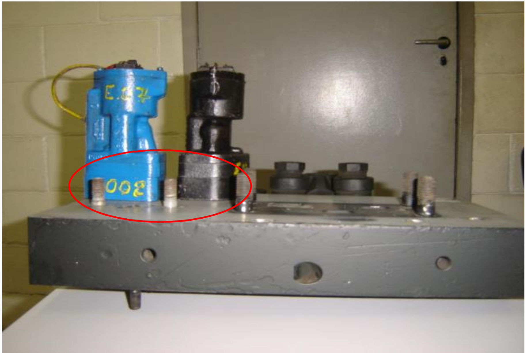
FIGURA 6: ACOPLAMENTO DAS VÁLVULAS N3D / N3E NA BASE DA UNIDADE OPERANTE SERVOTROL.
